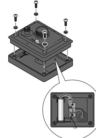
3. Lösen Sie die Schrauben auf der Unterseite des Solarmoduls mit einem Kreuzschlitzschraubendreher und nehmen Sie die Abdeckung ab. Achten Sie dabei darauf, keine Kabel abzureißen!
