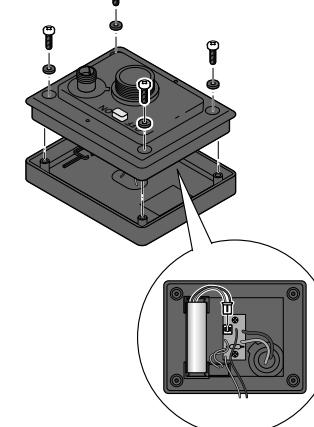
3. Desserrez les vis sur la face inférieure du module solaire avec un tournevis cruciforme et retirez le cache. Faites attention à ne pas arracher de câbles!
